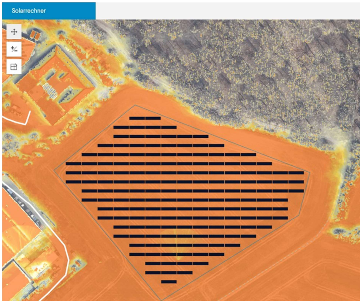
Abbildung 39: Screenshot Solarthermieanlage mit ca. 7.000 2 Bruttokollektorfläche Stadtfeld
